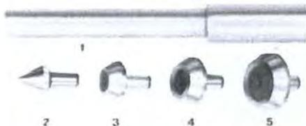
Jeu de cônes de centrage pour mesure d'entr'axes de petits alésages se composant de: une tige-support de 150 mm de long en acier trempé, rectifié avec cône intérieur  $2^\circ$  (TV 2 S 1), cône  $\varnothing$  0-15 mm (TV 2 S 2), cône  $\varnothing$  14-20 mm (TV 2 S 3), cône  $\varnothing$  18-24 mm (TV 2 S 4), cône  $\varnothing$  23-30 mm (TV 2 S 5). Autres diamètres sur demande.
