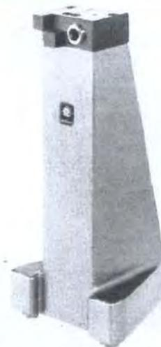
Jauge d'étalonnage pour cônes, appareils de centrage et pour la détermination de la constante du palpeur (distance de la base au centre de l'alésage et à l'élément à surfaces de mesures supérieures et inférieures:  $300 \text{ mm} \pm 2 \mu\text{m} / 12'' \pm .00008''$ ). 3 appuis en métal dur.
